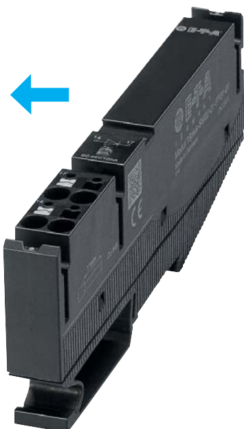
Signalmodul 18plus-SM Kl. 14 (Signalkontakt-Ausgang), Kl. 17 (GND für integrierte Signal- bürde 10 mA mit LED-Anzeige)
