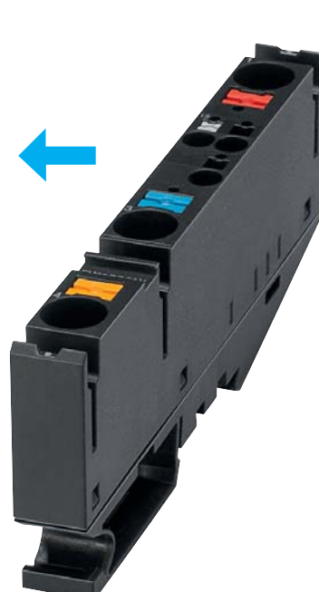
Einspeisemodul 18plus-EM Kl. 1 (LINE +), Kl. 3 (0 V), Kl. 4 (FE) Kl. 13 (Signalkontakt-Eingang)
