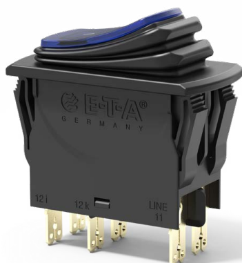
Bild 2: Schutzschalter Typ 3120-N mit Faltenbalgabdichtung und Snap-in Montage (Abdichtung des Betätigungsbereiches und der Einbauöffnung)
