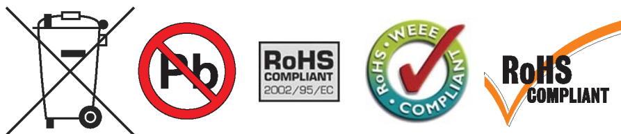
Bild 1. Verschiedene Symbole zur Kennzeichnung der Richtlinien-Konformität von Produkten. Gesetzlich geregelt ist nur die durchgekreuzte Abfalltonne
